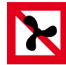
A-2 Verbot der Durchfahrt für Schiffe mit Maschinenantrieb Interdiction de passer pour bateaux motorisés
