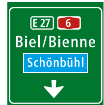
4.69 Einspurtafel über Fahrstreifen auf Autobahnen und Autostrassen Panneau de présélection au-dessus d'une voie de circulation sur autoroutes et semi-autoroutes
