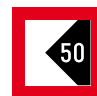
C-3 Das Fahrwasser ist einge- engt; Abstand in Metern (m), in dem sich Schiffe vom Ufer entfernt halten sollen Le chenal est limité; distance (m) à laquelle il convient que les bateaux se tiennent par rapport à la rive
