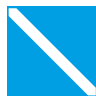
E-11 Ende eines Verbotes oder Gebotes Fin d'une interdiction ou d'une obligation
