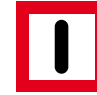
B-5 Gebot, besondere Vorsicht walten zu lassen Obligation d'observer une vigilance particulière
