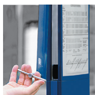
Seitliche Sperreiste zum Modulaustausch entfernen Retirer la barre de blocage latérale pour l'échange de module
