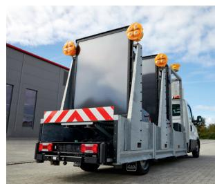
Beim Auf- und Abbau der Anzeigetafeln mit der Hebebühne des Drop & Pick Systems, bleibt der Fahrer im Fahrzeug.
