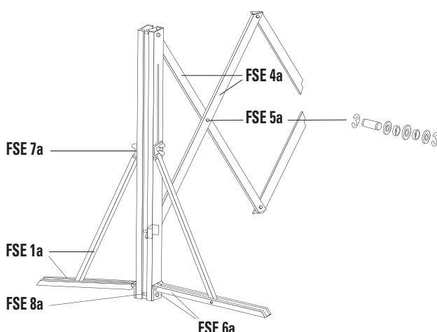
**FSE 1a** Klappfuß mit Verbindungsstrebe, als Einheit montiert
