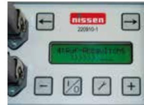
Verschiedene Programme sind mittels Steuergerät wählbar
