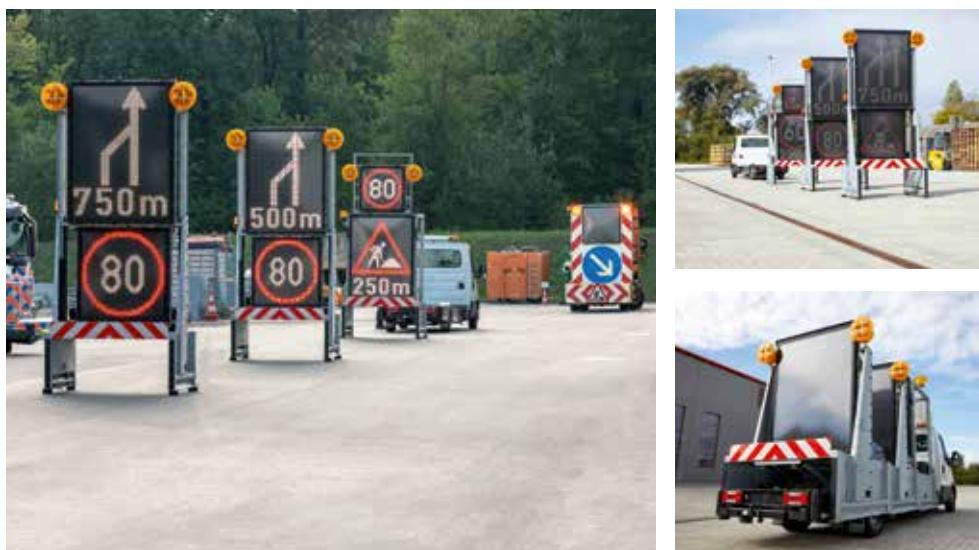
Beim Auf- und Abbau der Anzeigetafeln mit der Hebebühne des Drop & Pick Systems, bleibt der Fahrer im Fahrzeug.
