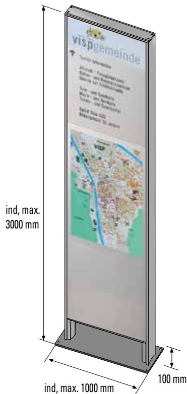
Variante 1 Beschriftungstafel standardmässig mit einem Mindestabstand ab Boden von 100 mm Panneau standard à une distance minimale de 100 mm du sol
