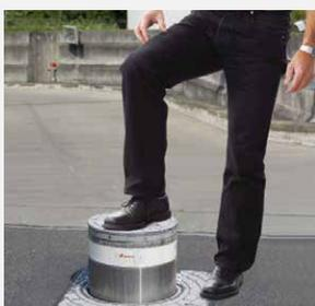
Um den Poller auszufahren, wird mit Hilfe eines Schlüssels das Halterungssystem entriegelt. Das Ausfahren erfolgt automatisch durch einen Gasdruckdämpfer. Abgesenkt wird der Poller durch das Niederdrücken mit dem Fuss, das Halterungssystem blockiert den Poller von selbst.
