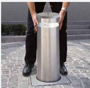
Die Poller können mit einem Schlüssel entriegelt und abgenommen werden. Abnehmbare Poller kommen insbesondere dann zum Einsatz, wenn aufgrund der Verlegetiefe keine automatischen oder halbautomatischen Poller eingesetzt werden können.
