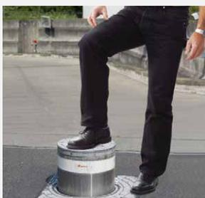
Pour sortir la borne, le système de fixation est déverrouillé à l'aide d'une clé. La sortie se fait de manière automatique par un piston à pression de gaz. La borne est abaissée par une pression du pied, le système de fixation bloquant la borne automatiquement.
