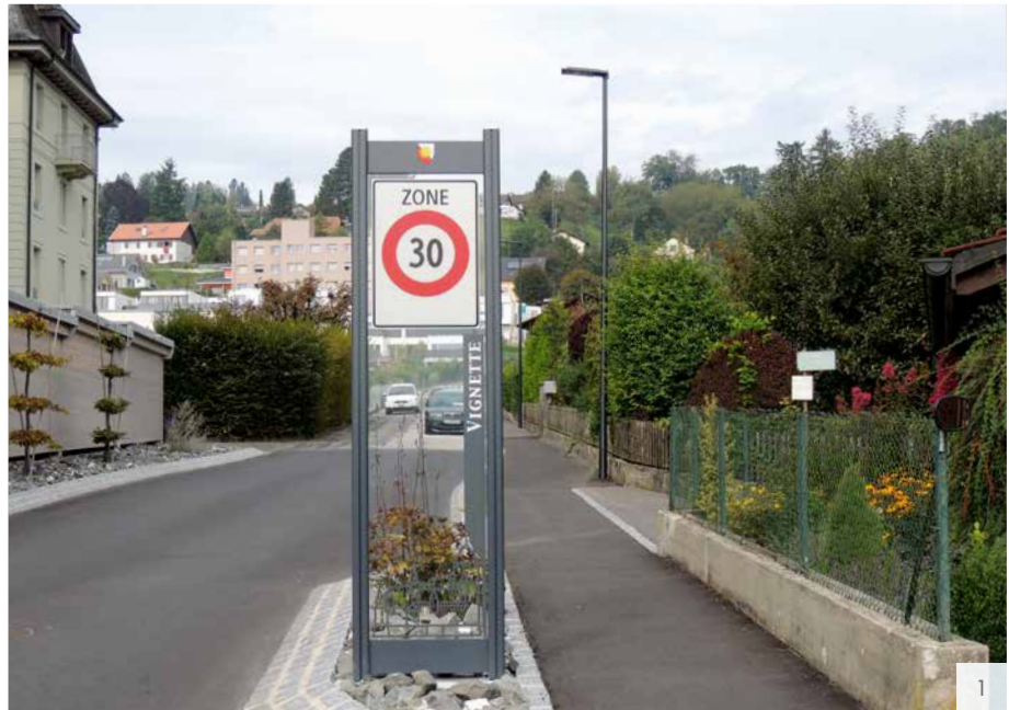
Bild 1: Eine Stele mit Durchblick für erhöhte Sicherheit aller Verkehrsteilnehmenden: Das heranahende Auto ist von Weitem erkennbar, obwohl es von der Stele «verdeckt» ist.
