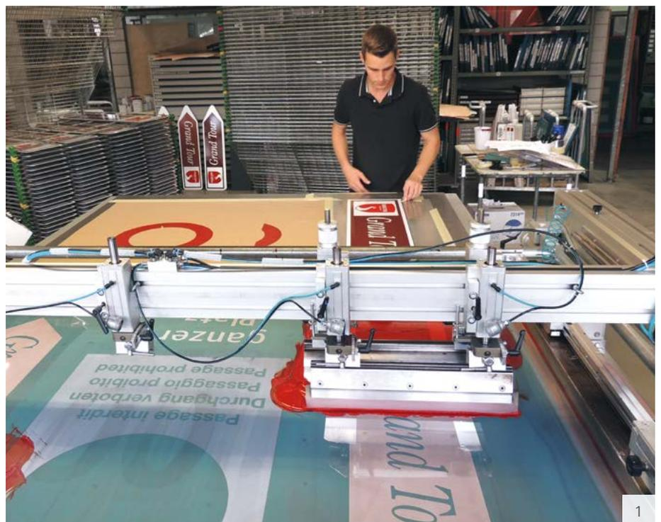
Bild 1: Produktion der Wegweiser im Siebdruck der SIGNAL AG.
