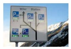
Das System umfasst vier offene Parkplatzanlagen und ein Parkhaus mit offenem Dachparking (P1). Alle Standorte ausser das P1 sind mit Netzkabel verbunden. Die Steuerzentrale des Parkleitsystems ist zentral bei der Kasse platziert und an die bestehende Schnittstelle des alten Systems angebunden. Dadurch ist gewährleistet, dass sowohl der ältere Teil als auch die neu installierte Anlage über das Netz bedient werden kann. Einzig das Parking P1 auf dem Dach des Parkhauses wird über Funk angesteuert.
