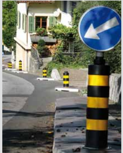
Verkehrinseln und Inselfosten aus Recycling-Kunststoff
