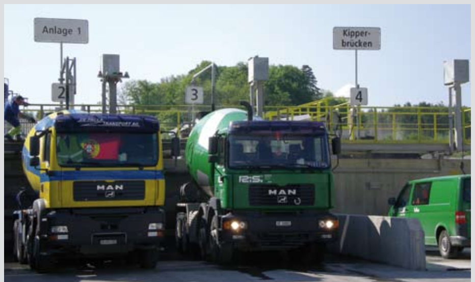
Muldenspülstation mit nummerierten Boxen und jeweiliger Information
