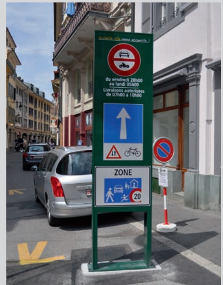
Steile Signa SCALA – Signalisation und Steuerkasten zugleich
