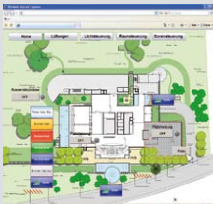
Einfache Bedienung der Poller über die Gebäudeleittechnik
