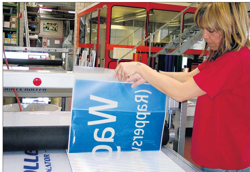
Exaktes Arbeiten ist gefragt: Die Mitarbeiterin entfernt die Folie vom Träger und klebt sie auf das Schild.
