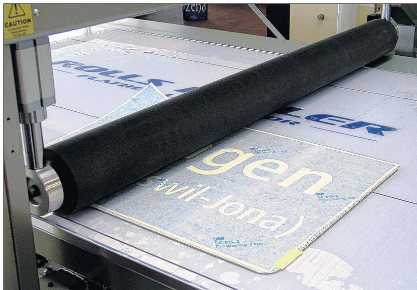
Wagen wird kurz plattgewalzt: Nachdem die Folie gleichmässig angedrückt ist, wird der weissliche Schutzfilm abgezogen, und das neue Schild ist fertig.
