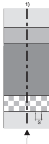
Trapezförmiger Versatz Décrochement de forme trapézoïdale
